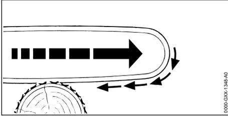
Lorsqu'on travaille avec le côté inférieur du guide-chaîne, la tronçonneuse est tirée dans le sens opposé à l'utilisateur.
